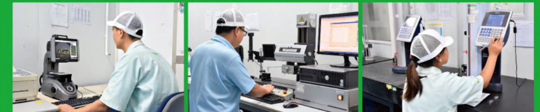
キーエンス画像寸法測定器 One-Button Image Measurement
